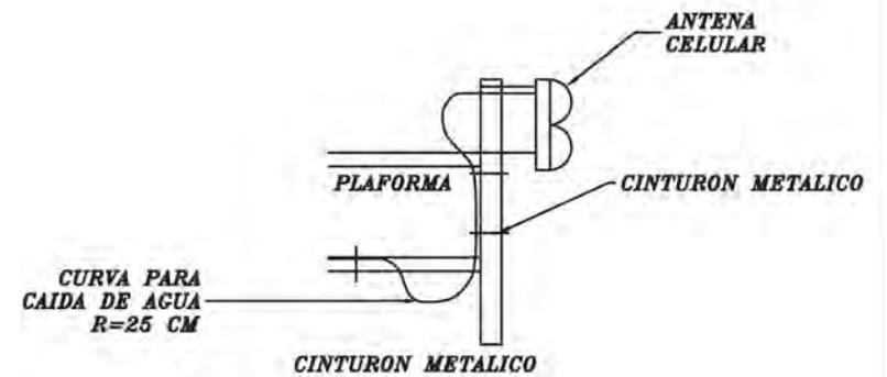
**FIJACION DE FEEDERS Y JUMPER EN PLATAFORMA**
