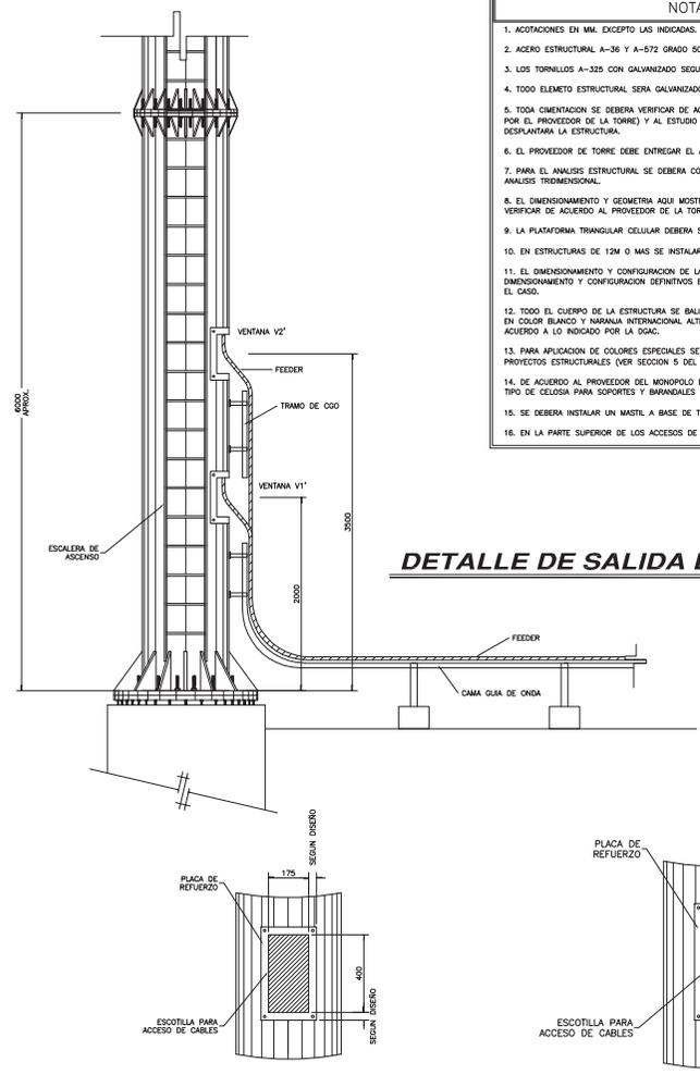
**DETALLE DE SALIDA DE FEEDERS**
