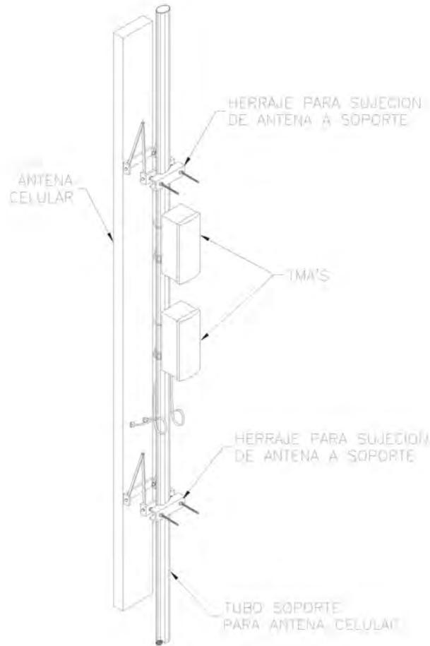
EL HERRAJE PARA SUJECION DE ANTENA A SOPORTE (TUBO  $\varnothing=2"$  CED. 40) PODRÁ SER DE VARIAS FORMAS DEPENDIENDO DEL FABRICANTE DE LA ANTENA, SIEMPRE Y CUANDO CUMPLA CON LAS SIGUIENTES CONDICIONES:
