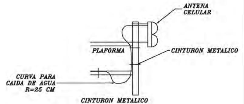
**FIJACION DE FEEDERS Y JUMPER EN PLATAFORMA**
