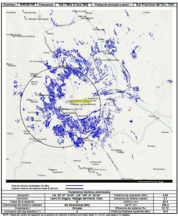
ACESLI, Altura del centro eléctrico de radiación sobre el lugar de Instalación.
