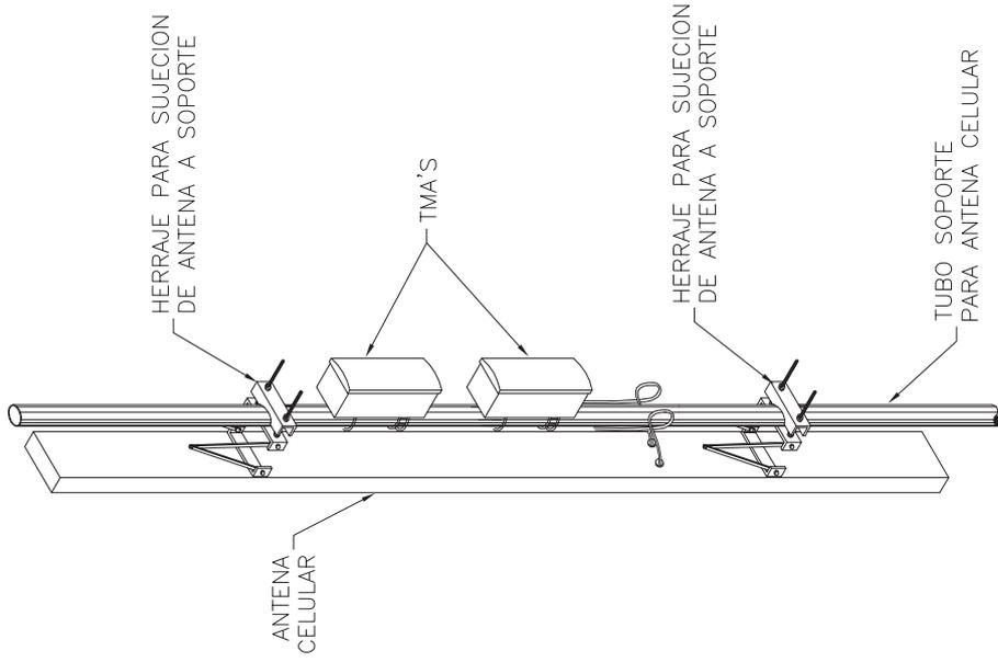
EL HERRAJE PARA SUJECION DE ANTENA A SOPORTE (TUBO  $\phi=2"$  CED. 40) PODRA SER DE VARIAS FORMAS DEPENDIENDO DEL FABRICANTE DE LA ANTENA, SIEMPRE Y CUANDO CUMPLA CON LAS SIGUIENTES CONDICIONES:
