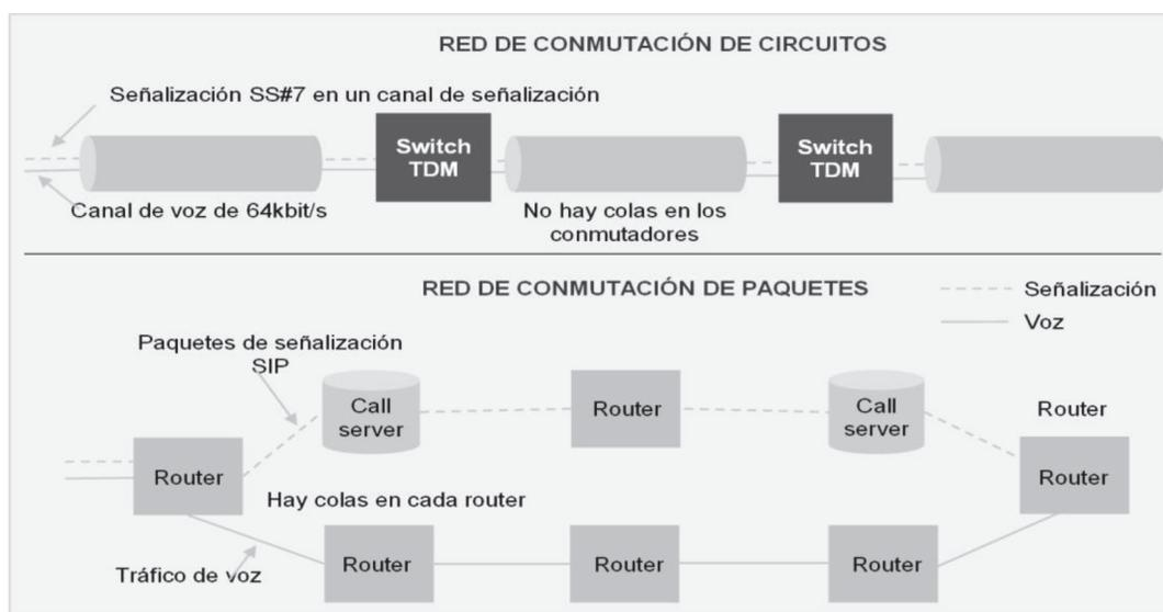
Figura 2. Comparación entre redes de conmutación de circuitos y de conmutación de paquetes
