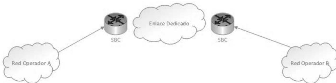
Figura 1. Topología de interconexión SBC-SBC
