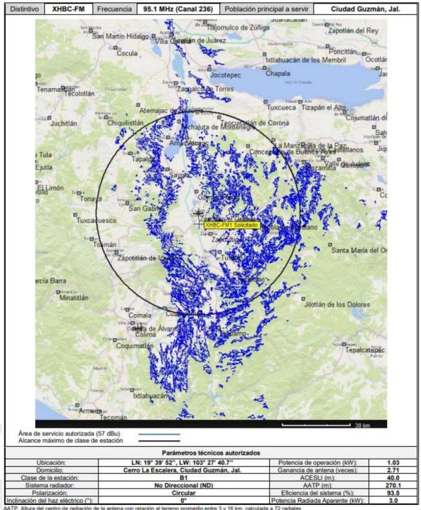
AATP, Altura del centro de radiación de la antena con relación al terreno promedio entre 3 y 16 km, calculada a 72 radiales ACESLI, Altura del centro de radiación de la antena sobre el lugar de instalación
