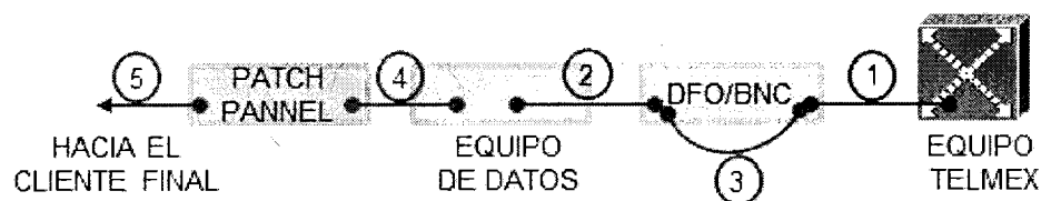
Responsabilidad de cableados en sala abierta.
