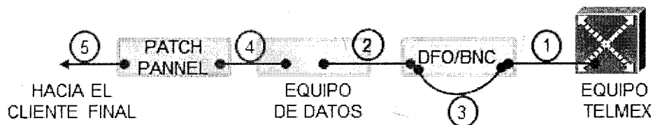
Responsabilidad de cableados en sala abierta.
