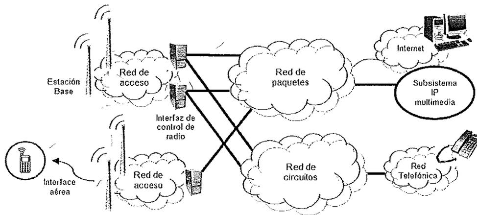
Esquema 2. Componentes funcionales de una red móvil.
