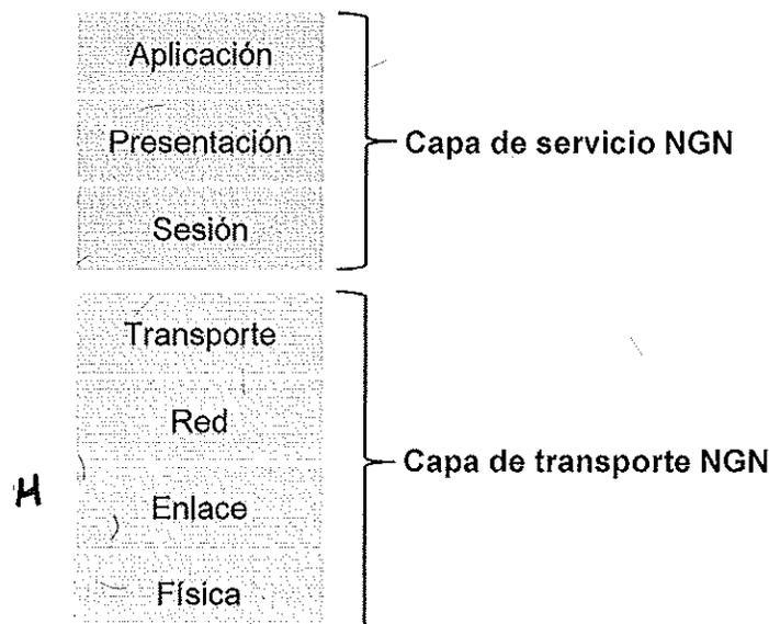
Figura 8: Mapeado entre las capas de servicio y transporte de una red NGN y el modelo de referencia OSI (Fuente: ITU, NGNuk)
