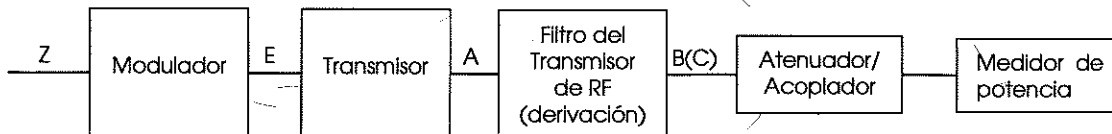
Figura 5. Configuración de prueba conducida para la potencia máxima de RF.
