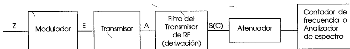
Figura 6. Configuración de prueba para la exactitud en frecuencia.
