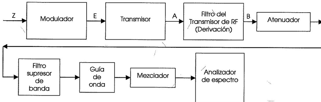
Figura 5. Configuración de prueba para emisiones no esenciales conducidas en el puerto de la antena.
