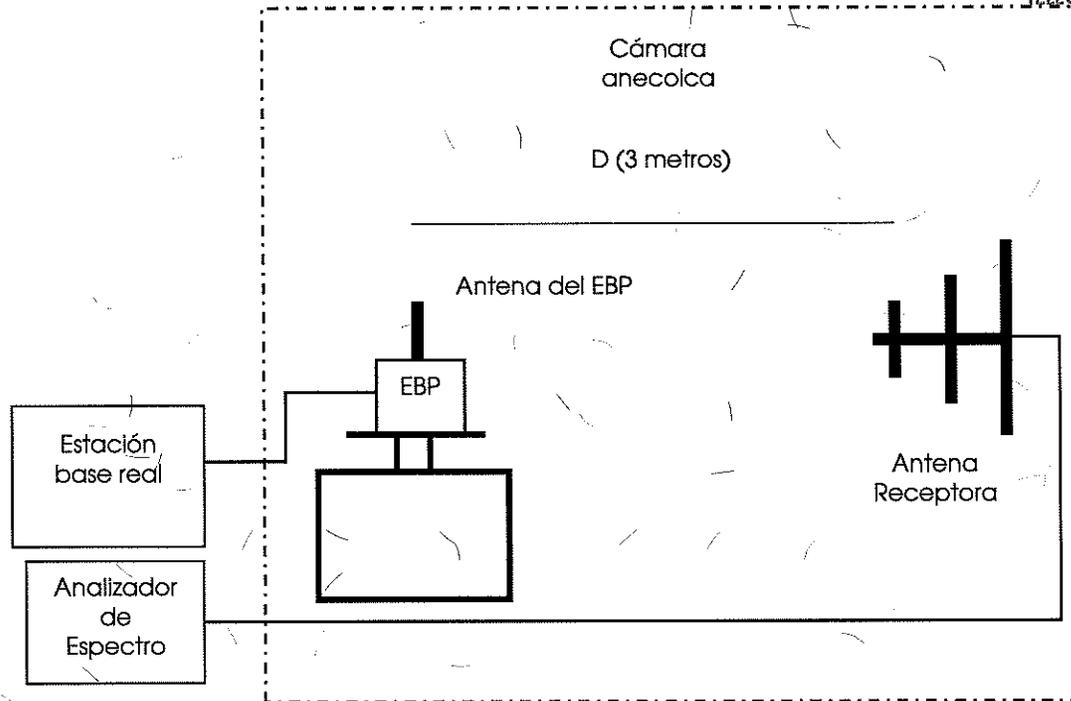
Figura 3. Configuración para medición de emisiones radiadas.
