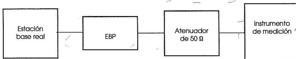
Figura 2. Configuración para medición de emisiones conducidas.
