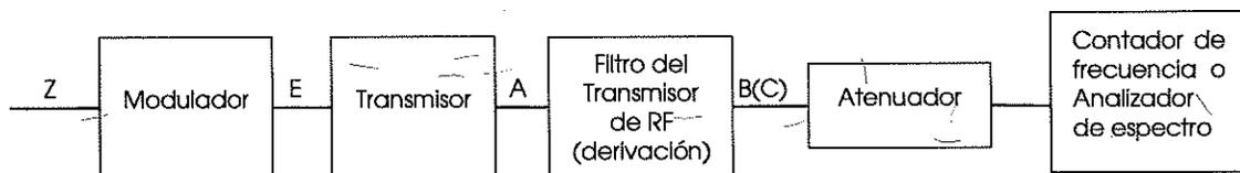
Figura 7. Configuración de prueba conducida para la exactitud en frecuencia.
