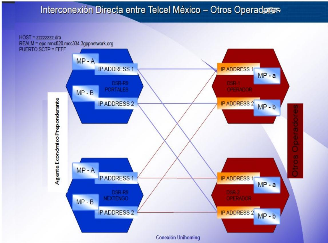
Figura 3: Diagrama de interconexión directa e indirecta vía señalización Diameter mediante interface S6a.
