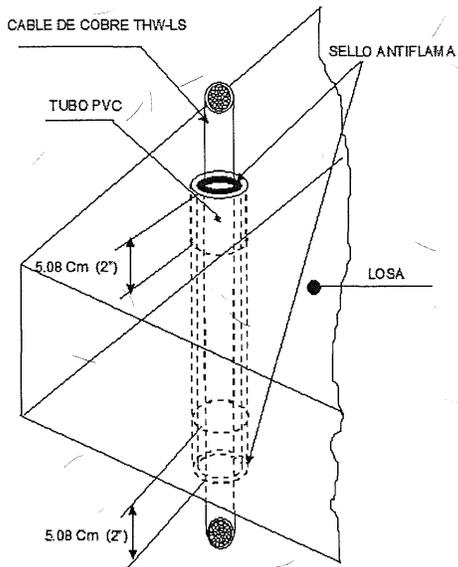
Paso del Cable por Muro Mediante Tubo
