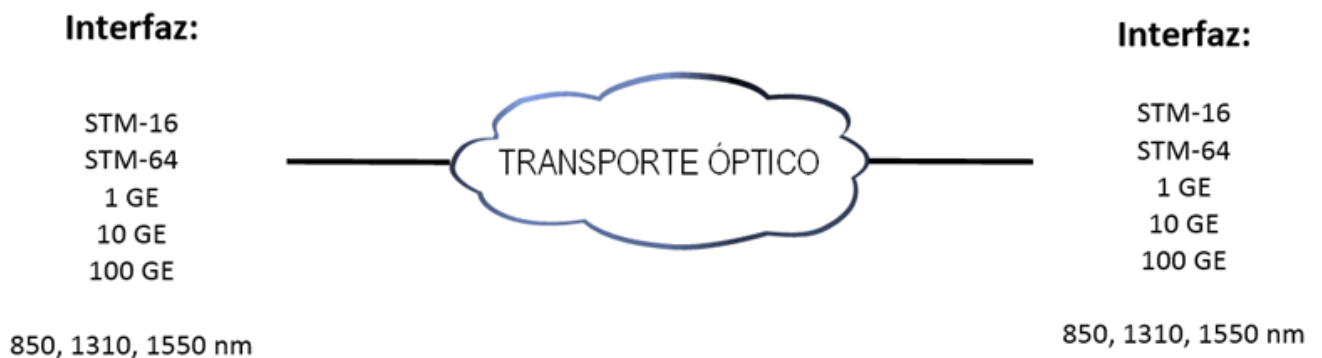
Figura 3 Arquitectura del servicio de canal óptico.
