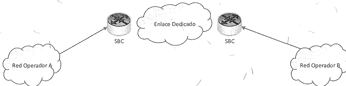
Figura 1. Topología de interconexión SBC-SBC
