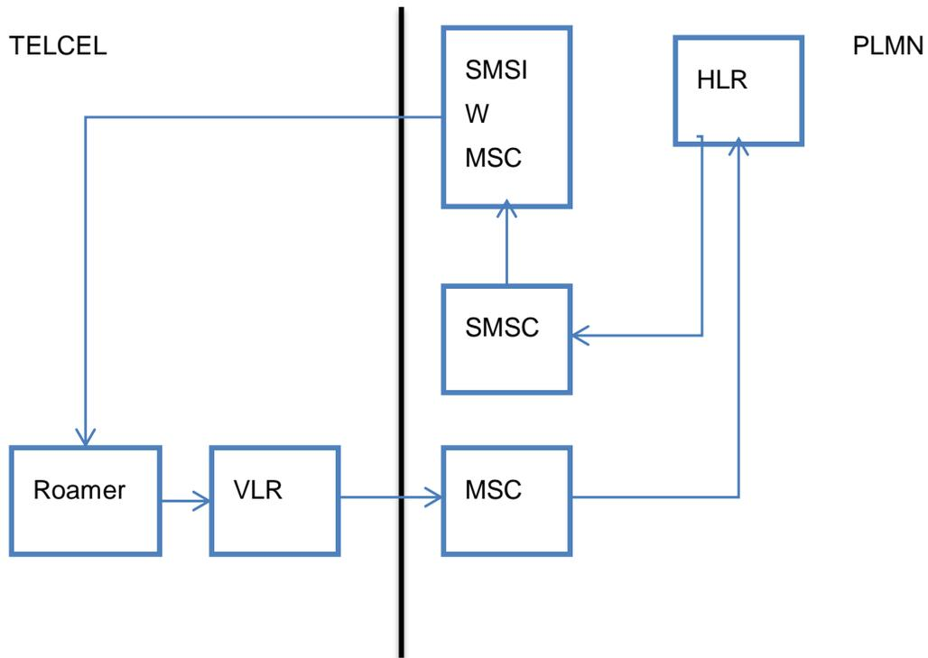
Cuando un Usuario Final envía un SMS proveniente del Concesionario y/u otro operador, el VLR de Telcel invoca el procedimiento de envío de mensaje MAP MO hacia el SMIW MSC en la red del Usuario final, el cual lo envía al SMSC para su entrega. El cobro en tiempo real de los servicios para usuarios prepago se realiza a través del protocolo de CAMEL v2 o v3.
