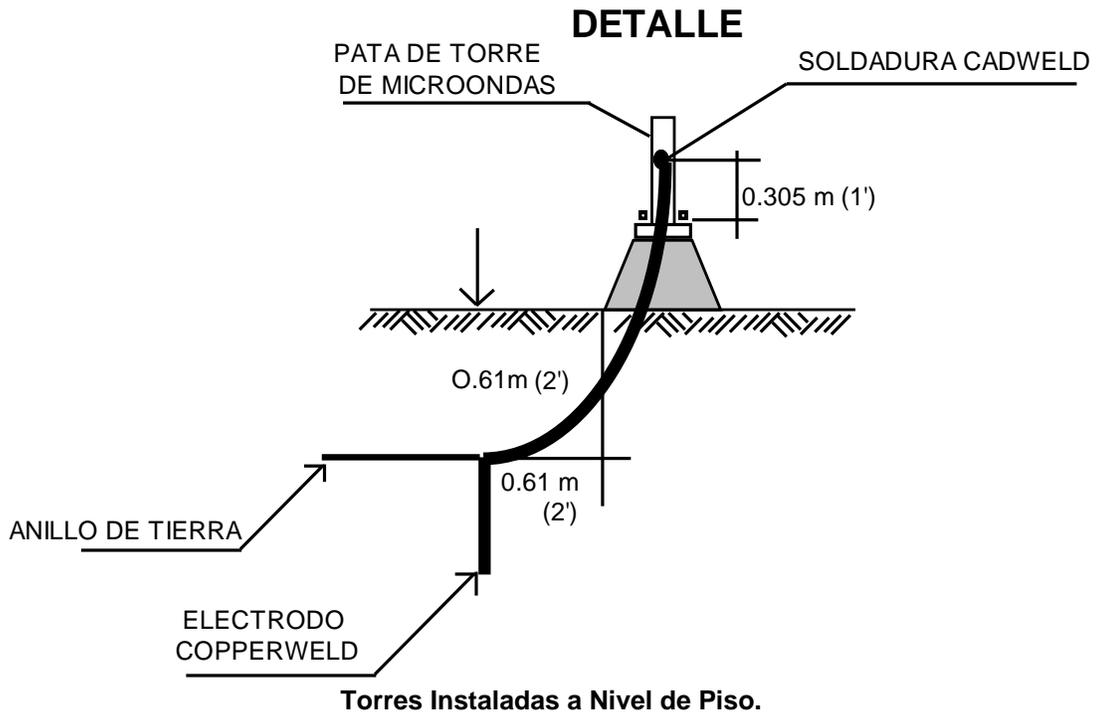
d. Las retenidas de las torres en el piso, deben ser puestas a tierra con conectores tipo "C", bimetálicos y conectados con soldadura Cadweld a un electrodo Copperweld lo anterior se muestra en la siguiente figura:
