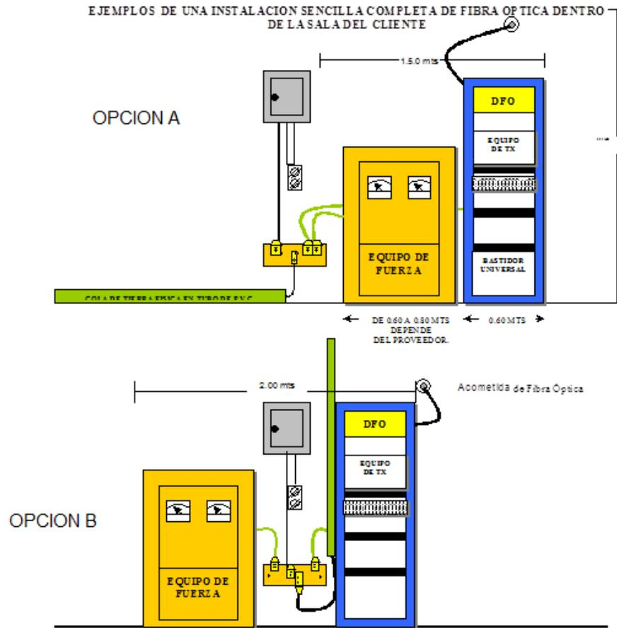
i. La capacidad del equipo de fuerza está en función del consumo del equipo de transmisión de acuerdo con lo indicado en las normas de instalación de cada fabricante.
