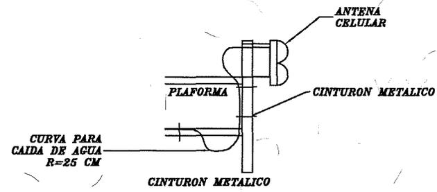
**FIJACION DE FEEDERS Y JUMPER EN PLATAFORMA**
