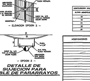
**DETALLE DE SECCION PARA CABLE DE PARARRAYOS**
