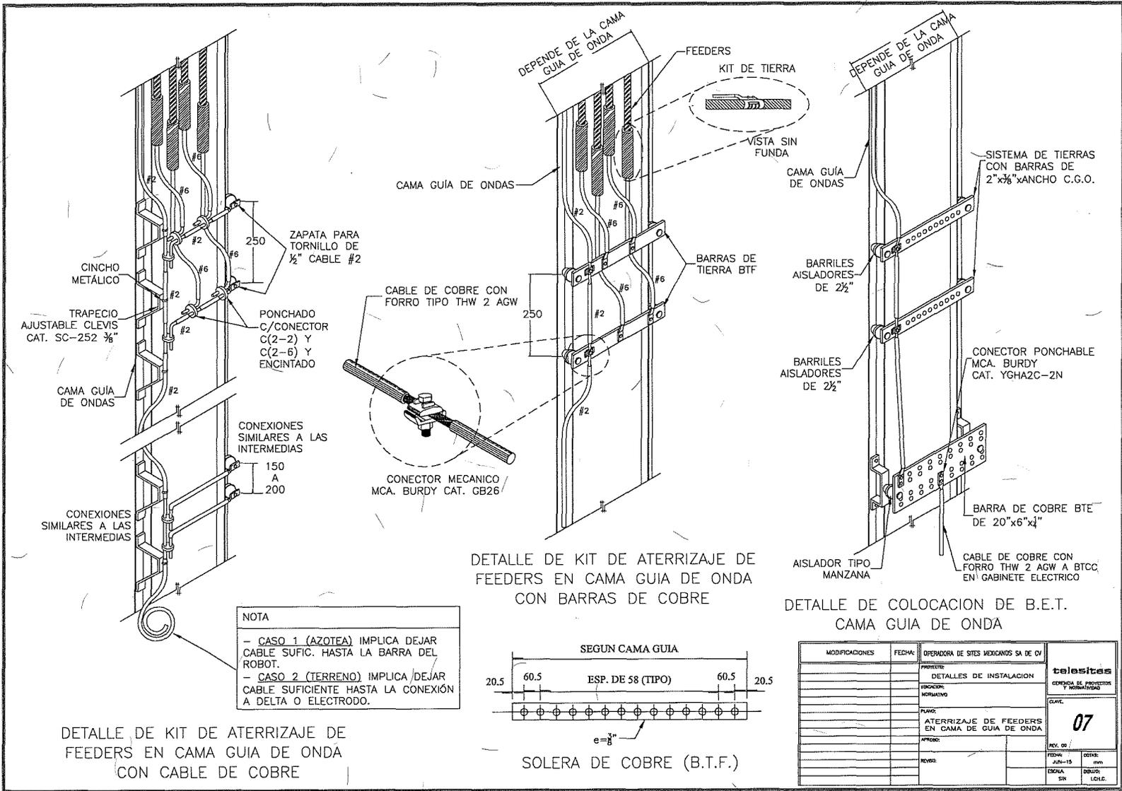
DETALLE DE KIT DE ATERRIZAJE DE FEEDERS EN CAMA GUIA DE ONDA CON CABLE DE COBRE
