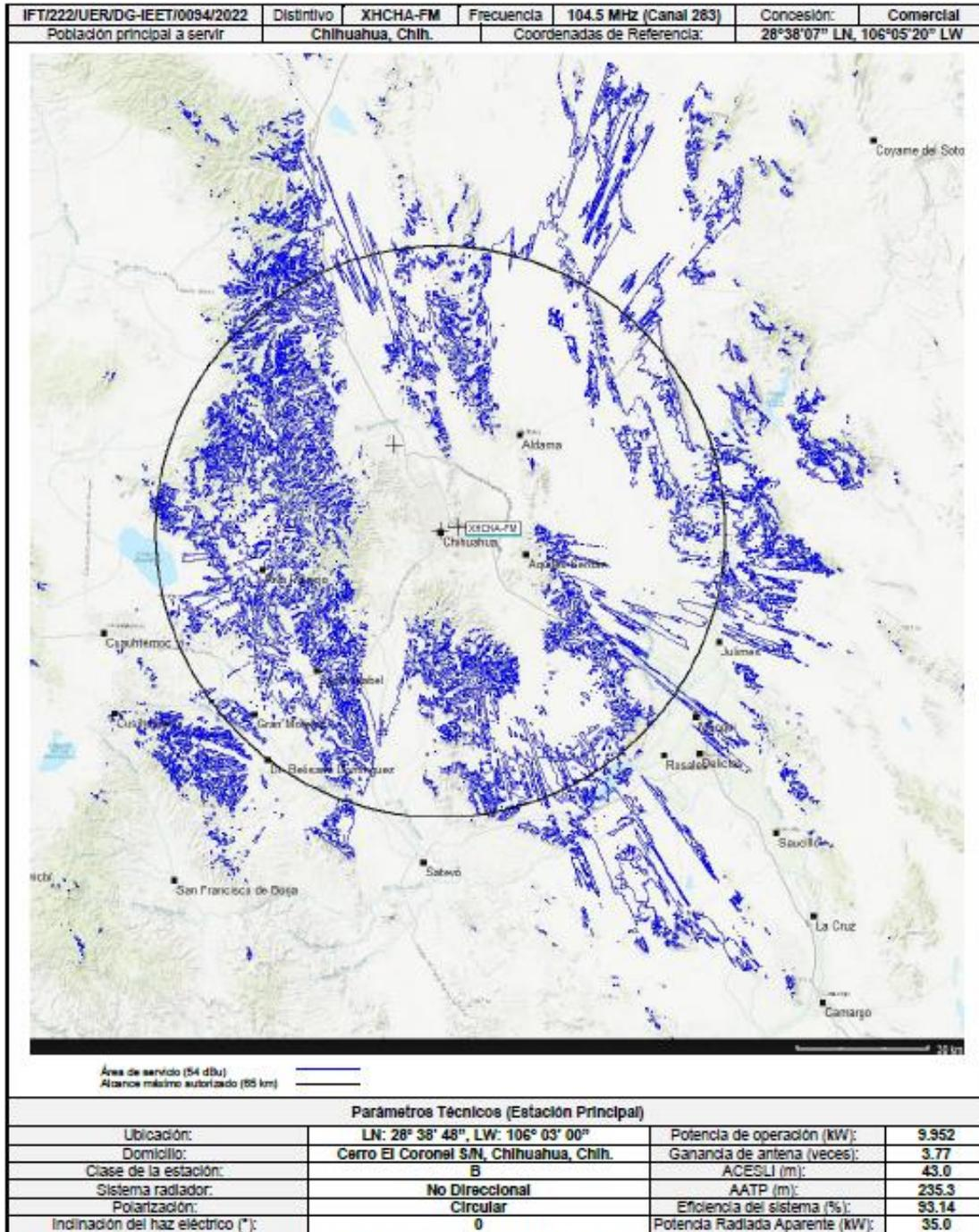
AATP, Altura del centro de radiación de la antena con relación al terreno promedio entre 3 y 16 km, calculada a 72 radiales.
