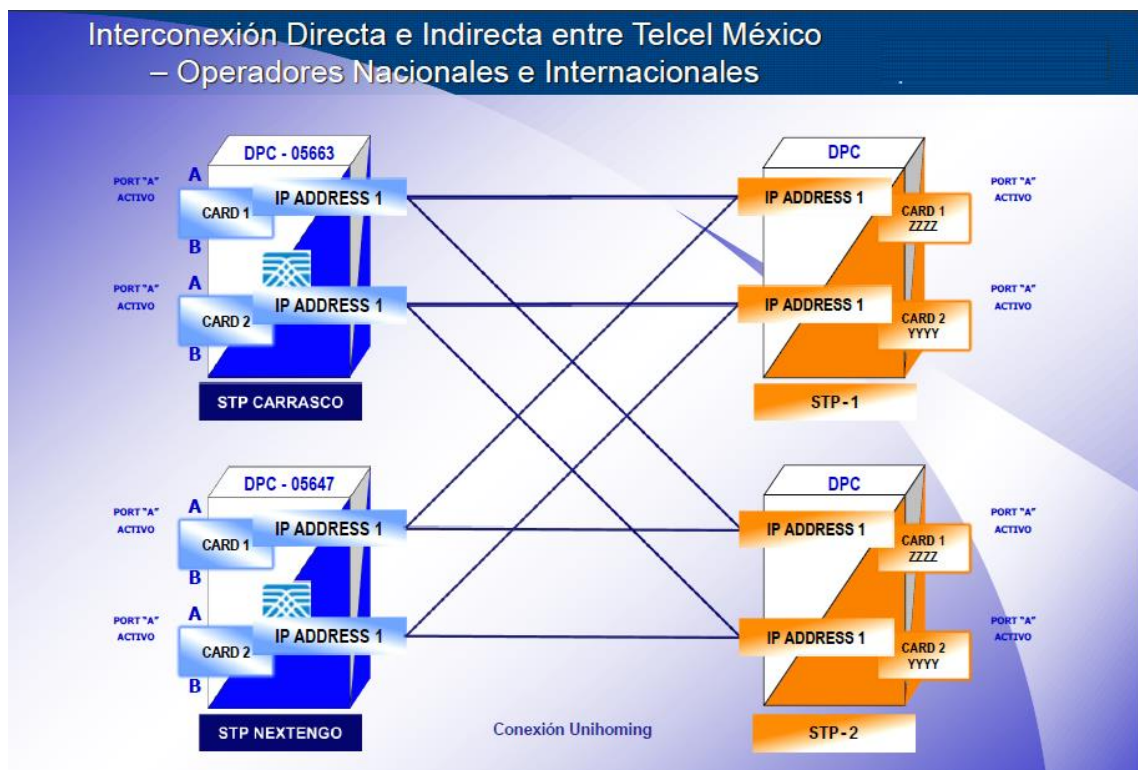
Figura 1: Topología requerida de interconexión de señalización con enlaces SIGTRAN M2PA entre Telcel y el Concesionario.
