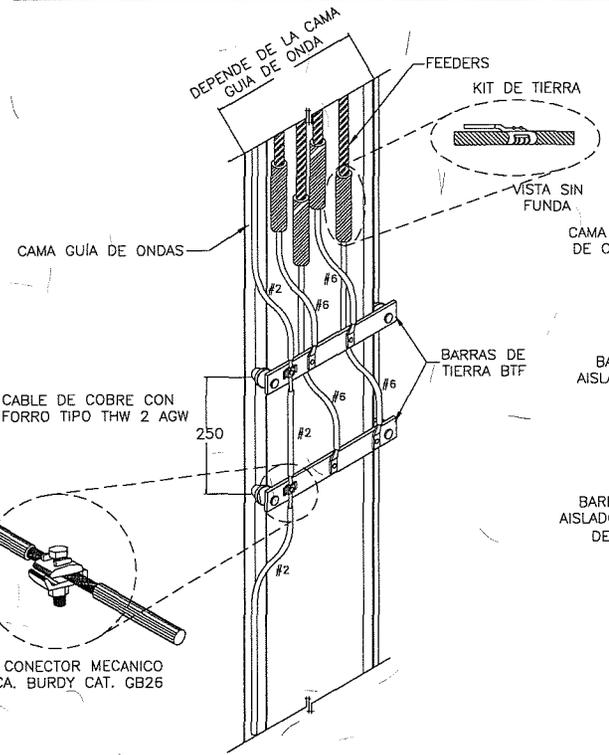
DETALLE DE KIT DE ATERRIZAJE DE FEEDERS EN CAMA GUÍA DE ONDA CON BARRAS DE COBRE
