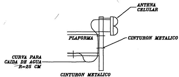
**FIJACION DE FEEDERS Y JUMPER EN PLATAFORMA**
