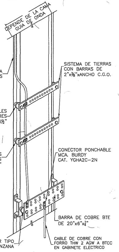
DETALLE DE COLOCACION DE B.E.T. CAMA GUÍA DE ONDA
