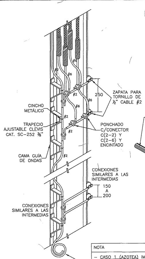
DETALLE DE KIT DE ATERRIZAJE DE FEEDERS EN CAMA GUÍA DE ONDA CON CABLE DE COBRE
