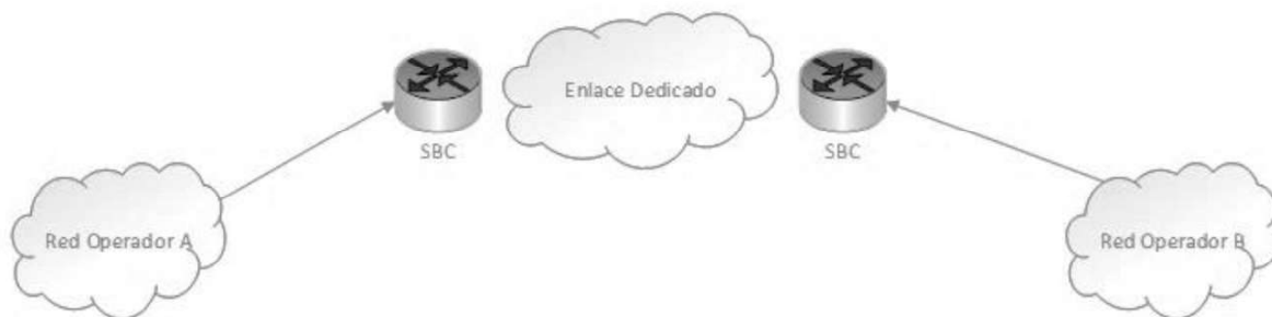
Figura 1. Topología de interconexión SBC-SBC
