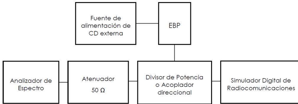
**Figura 1. Configuración para medición de emisiones conducidas**
