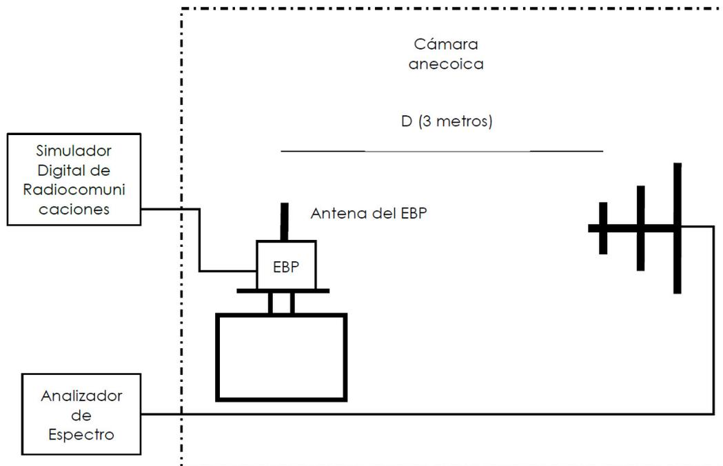
Figura 2. . Configuración para medición de emisiones radiadas
