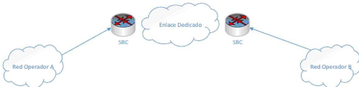
Figura 1: Topología de interconexión SBC-SBC
