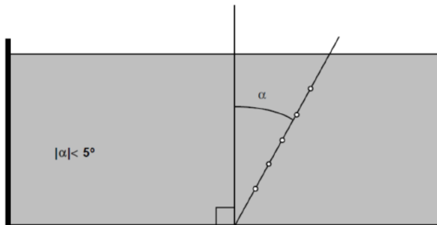
Figura 27. Orientación de la sonda de prueba con respecto de la normal a la superficie del MSH.
