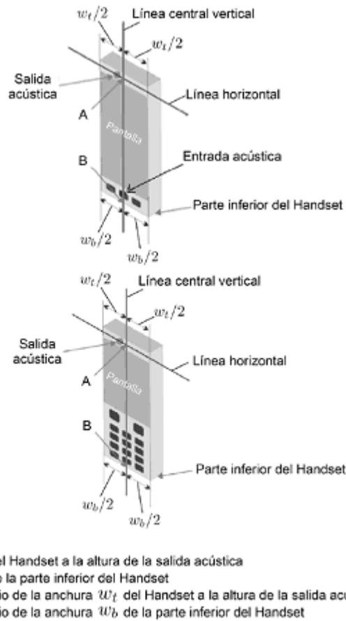
Figura 6. Líneas de referencias verticales y horizontales y puntos de referencia A y B en dos ejemplos de tipos de dispositivos: un teléfono inteligente con pantalla totalmente táctil (superior) y un Handset con teclado (inferior).
