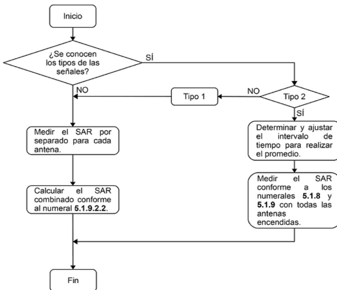
Figura 12. Procedimiento de medición para diferentes señales correlacionadas.
