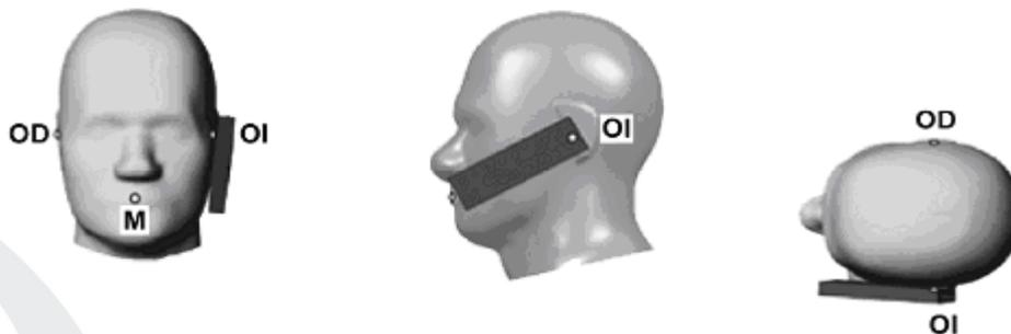
NOTA Se indican los puntos de referencia para el oído derecho (OD), oído izquierdo (OI) y boca (M), los cuales establecen el plano de referencia para el posicionamiento del Handset. Esta posición del DCI debe mantenerse para el arreglo de prueba con el MCH sagital mostrado en la Figura 04.
