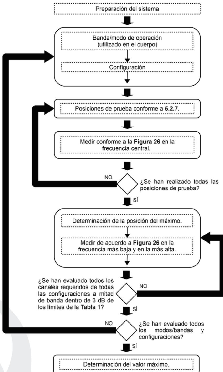
Figura 25. Diagrama de bloques de pruebas a realizar.
