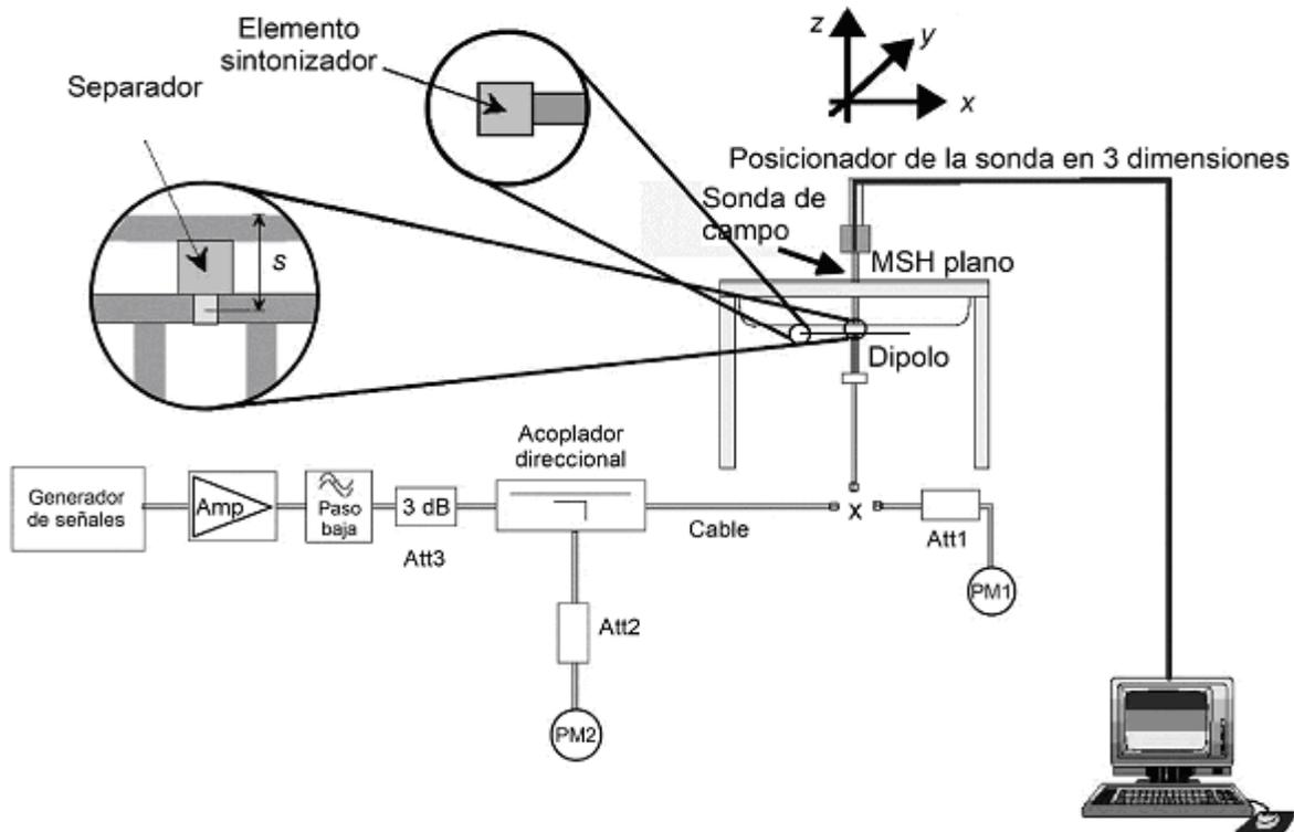
**NOTA** Este arreglo utiliza una antena dipolo como ejemplo para ilustrar una fuente para la revisión del sistema y las configuraciones de medición; arreglos iguales o equivalentes aplican para otras fuentes.
