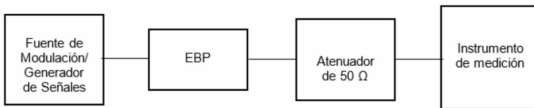
**Figura 1.- Configuración para medición de emisiones conducidas.**
