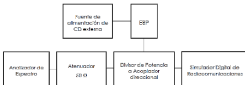
Figura 1. Configuración para medición de emisiones conducidas
