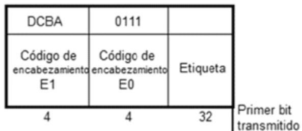
FIGURA 41.- Mensaje de reanudación de tráfico autorizada.
