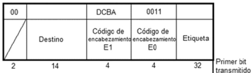
FIGURA 42-B.- Mensaje de transferencia controlada.
