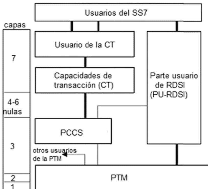
FIGURA 2.- Arquitectura del sistema de señalización N.º 7.
