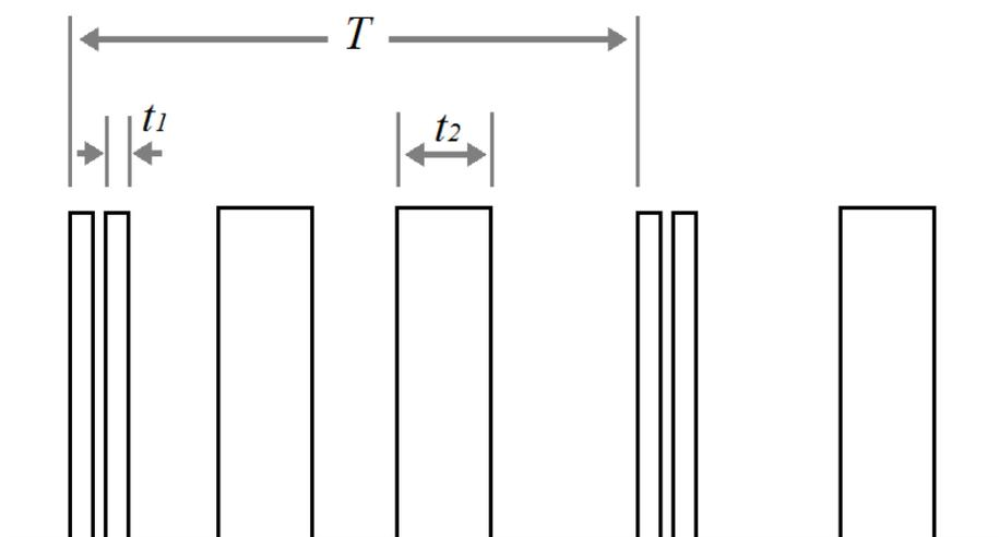
Figura 4 – Emisiones pulsadas con dos diferentes duraciones en los pulsos (por ejemplo si,  $t_1=1$  ms,  $t_2=5$  ms,  $\alpha_1=2$ ,  $\alpha_2=2$ ,  $T=25$  ms, entonces  $\delta(dB) = -6,38 dB$ )
