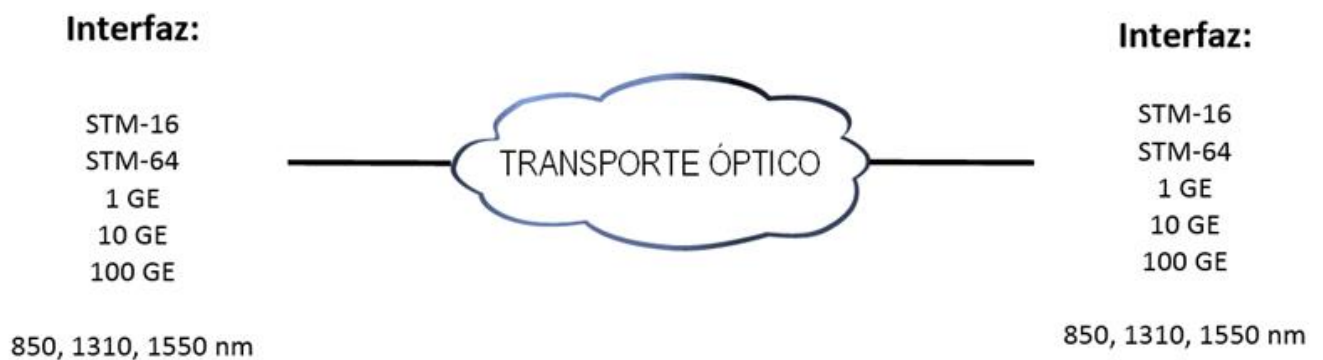
Figura 3 Arquitectura del servicio de canal óptico.
