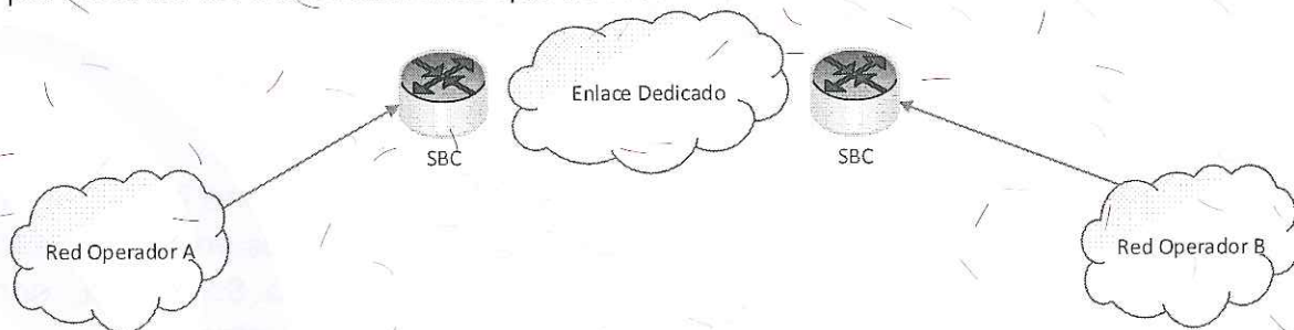
• Figura 1: Topología de interconexión SBC-SBC
