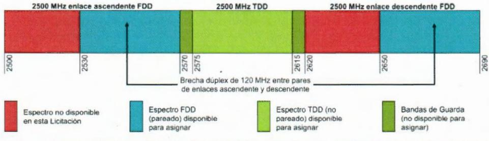
Los segmentos de espectro 2570-2575 MHz y 2615-2620 MHz componen la Banda de Guarda establecida para asegurar la adecuada separación de frecuencias entre el uso de alta potencia de la tecnología de Duplexaje por División de Frecuencia (FDD) en los Bloques Categoría FDD y Duplexaje por División de Tiempo (TDD) en los Bloques Categoría TDD, por lo que no son objeto de la Licitación.
