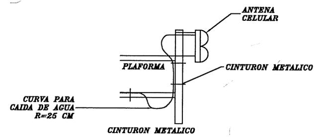
**FIJACION DE FEEDERS Y JUMPER EN PLATAFORMA**
