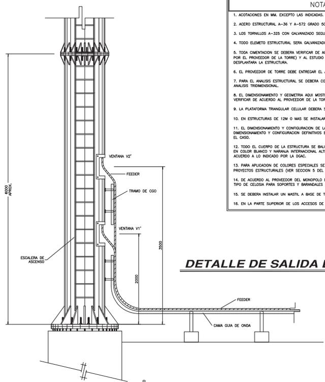
**DETALLE DE SALIDA DE FEEDERS**
