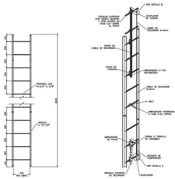
**ESQUEMA DE DISPOSITIVO DE SEGURIDAD MCA. MICROFLECT**
