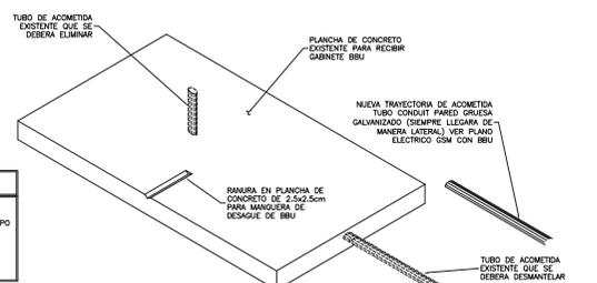
**ISOMETRICO PLANCHA DE CONCRETO**
