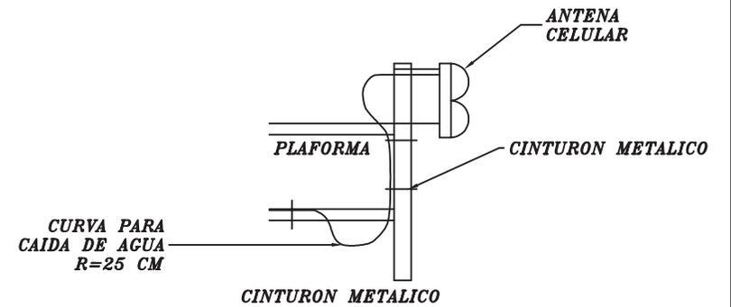
**FIJACION DE FEEDERS Y JUMPER EN PLATAFORMA**
