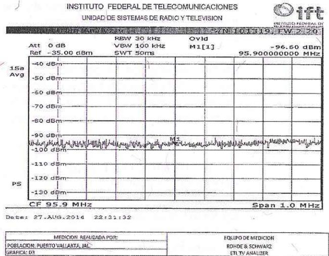
Figura 2.- Intensidad de la señal en la frecuencia 95.9 MHz. (I.F.T.)
